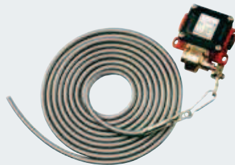
Interrupteur à tirette avec câble de traction synthétique Montage horizontal ou vertical, boîtier en aluminium moulé sous pression IP 65, longueur de câble 4 m
